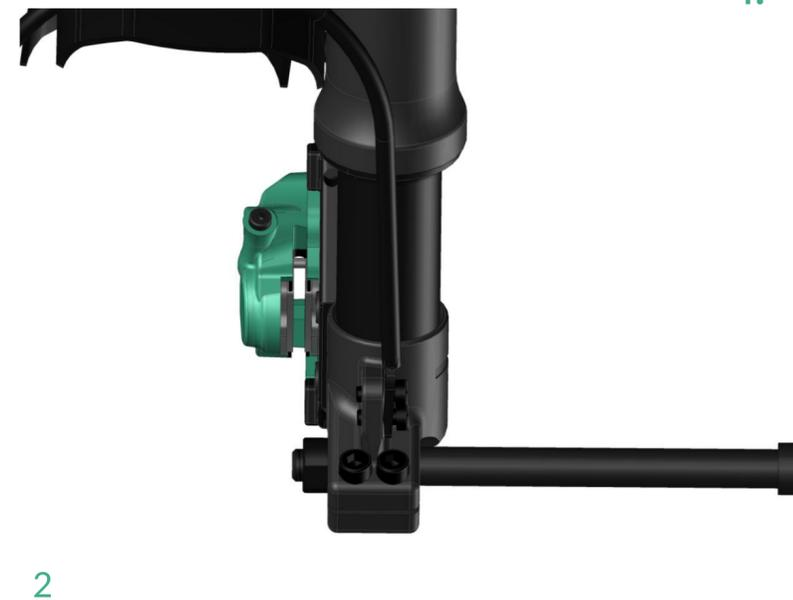
1. Positioniere die Achse und ggf. die rechte Distanzscheibe vor dem Einsetzen des Rades korrekt an der Gabel.
