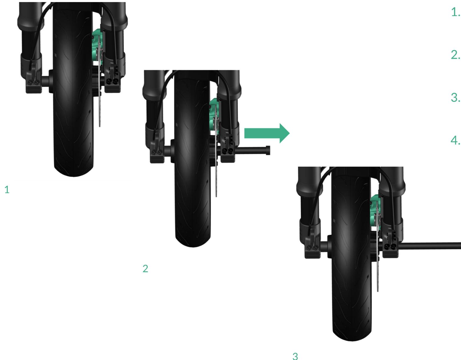
1. Nachdem du die Klemmschrauben gelöst hast, kannst du dich der Steckachse widmen.
