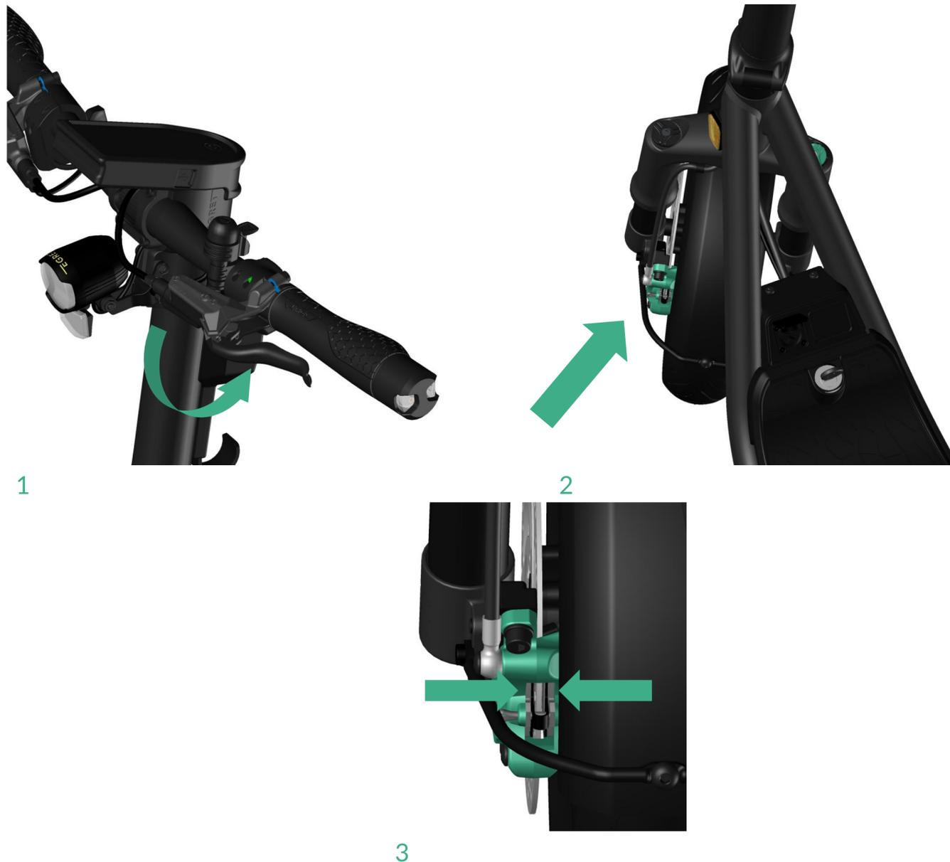
1. Ziehe nun den linken Bremshebel für die Vorderradbremse fest an (siehe Bild 1). Wenn du dafür den Lenker etwas nach rechts einschlägst (siehe Bild 2) kannst du erkennen, wie sich der Bremssattel bewegt. Wiederhole den Vorgang 1 – 2 Mal.
