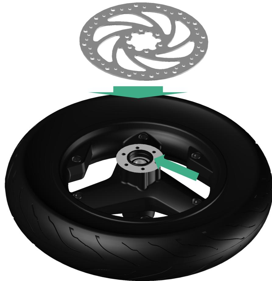
1. Setze die neue Bremsscheibe auf die Felge (siehe Bild 1) und drehe sie so, dass die Löcher übereinstimmen.
