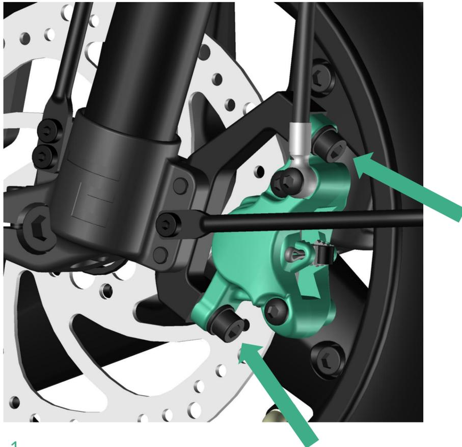
1. Während du immer noch den Bremshebel fest gezogen hältst, ziehst du nun die beiden Bremssattelschrauben (H 5) mit ca. 7 Nm fest (siehe Bild 1).
